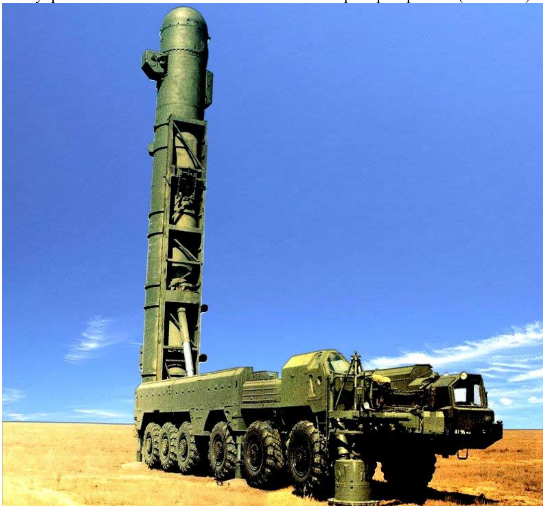
СПУ 15У106 комплекса 15П645 "Пионер" - SS-20 SABER в предстартовом положении (обработка фото из сборника "Оружие России", MilitaryRussia.Ru, 2011 г.).
