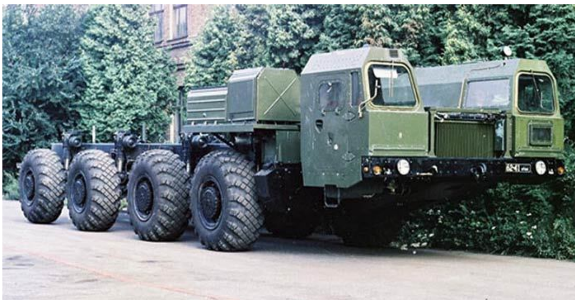
Шасси МАЗ-7908 на базе которого создана СПУ ПГРК "Скорость" ( http://www.russianarms.ru/forum ).
