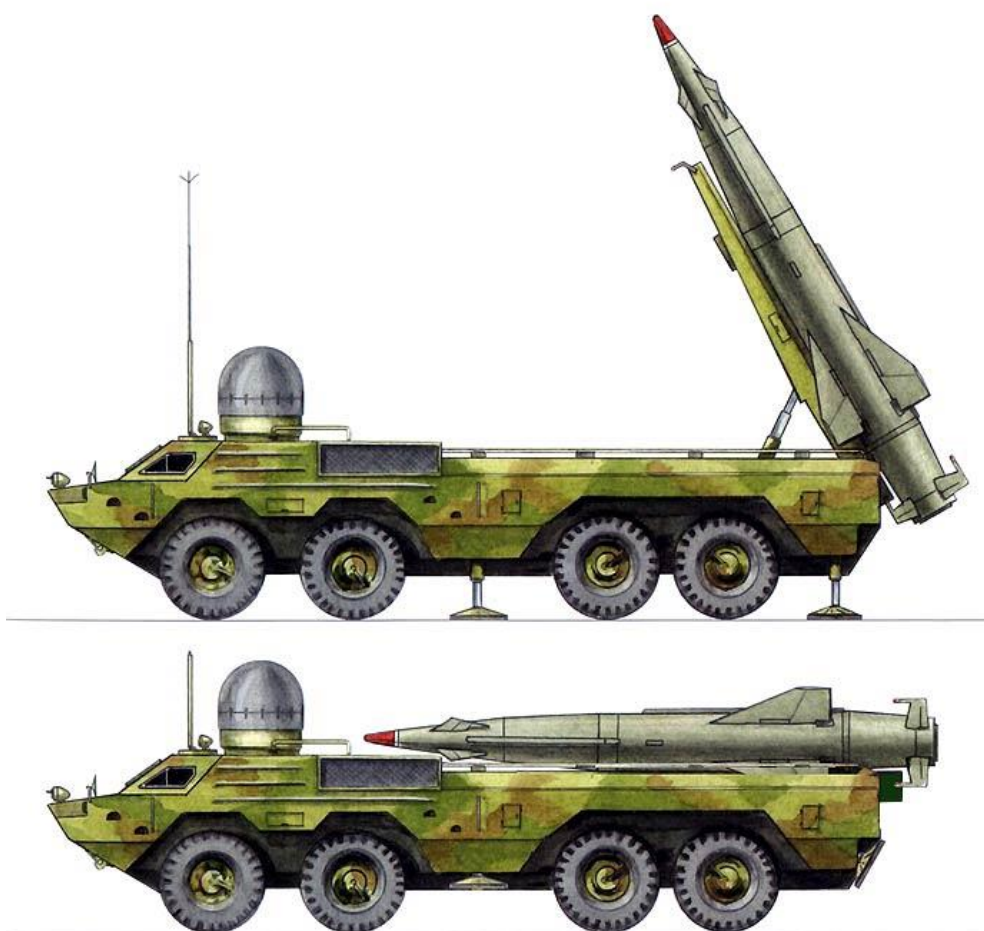
Эскиз комплекса "Ястреб" МКБ "Факел" (Ракеты "Факела". М., МКБ "Факел", 2003 г.) - "Точка" - СПУ на шасси БАЗ-135ЛМ (аналогичная СПУ комплекса "Луна-М" ).
